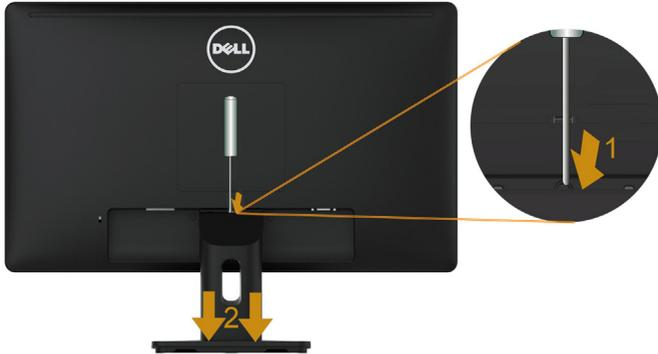
1. Utilice un destornillador largo para empujar el seguro de liberación situado en un orificio justo encima de la base.
