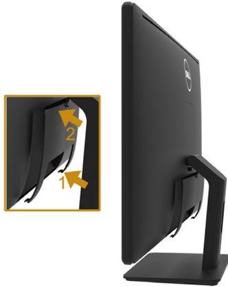
Para instalar la cubierta para cables:
