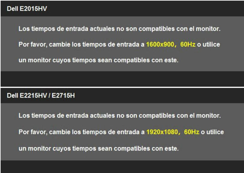
Esto significa que el monitor no puede sincronizarse con la señal que está recibiendo desde el PC. Consulte la sección **Especificaciones del monitor** para conocer los intervalos de frecuencia horizontal y vertical que puede manejar este monitor. El modo recomendado es 1600 x 900 (para el modelo E2015HV) o 1920 x 1080 (para el modelo E2215HV/E2715H).
