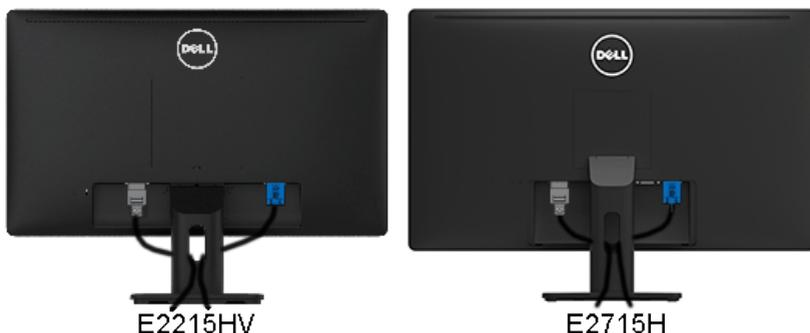
Una vez conectados todos los cables necesarios al monitor y al PC (consulte la sección Conectar el monitor para obtener más información sobre la conexión de los cables), organícelos como muestra la ilustración anterior.
