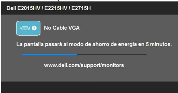
4. Este cuadro también aparece durante el funcionamiento normal del sistema en el caso de que el cable de vídeo se desconecte o sufra algún tipo de daño. El monitor entrará en el **modo de Ahorro de energía después de 5 minutos** si permanece en este estado.
